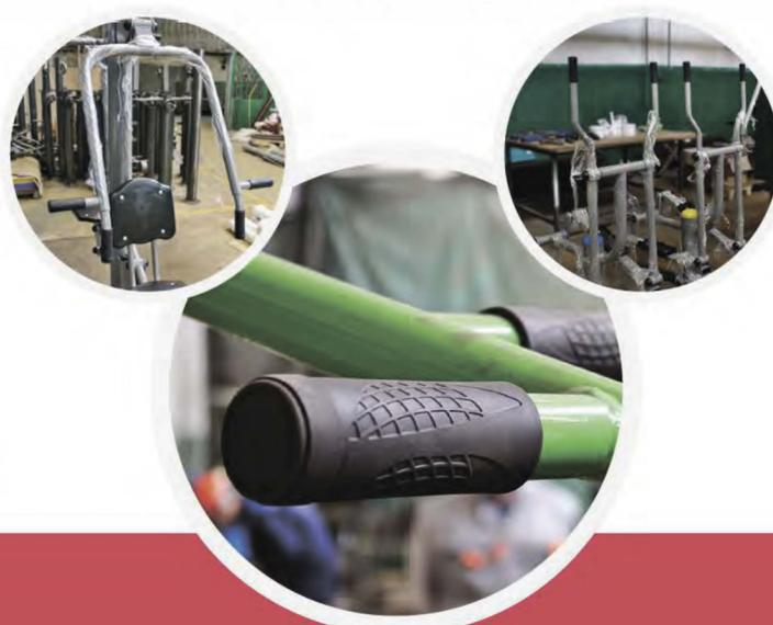
9. Сборка окрашенных узлов тренажеров, монтаж фурнитуры, запрессовка подшипников производится при помощи гидравлического пресса, динамометрического и простого инструмента.
