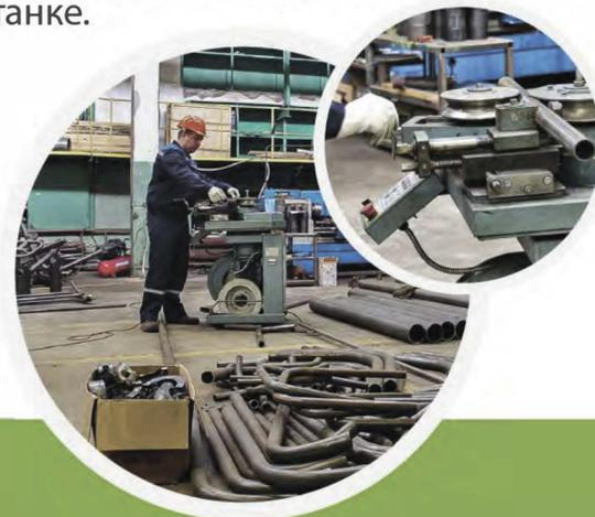
6. Изготовленные по чертежам детали на монтажных столах с применением кондукторов и мерительных инструментов собираются сваркой "на прихватках", и после проверки соответствия сборки узлов чертежам и приемки качества товара специальной комиссией, заготовки
